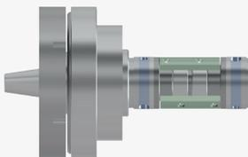
Mandrino con sistema de bloqueo cónico (ej. HSK). El control se realiza a través del colector sin contacto con forma de anillo
