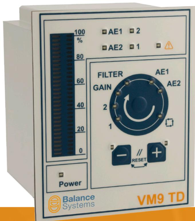
Automatische Antastkennung für Werkzeugmaschinen über Körperschallsensoren. Für die Installation an Neumaschinen und zur Nachrüstung. Einfache und kostengünstige Lösung für die:
