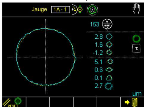
Analyse de la rondeur et contrôle de la forme
